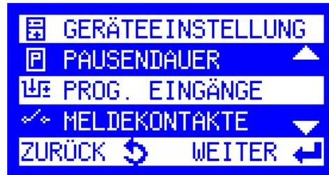
In der Grundausführung steht **1** programmierbarer Eingang zur Verfügung. Mit der Option "I/O Erweiterungsplatine", stehen nochmals **3** weitere Zusatzeingänge zur Verfügung.
