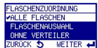
Diese Funktion ermöglicht die Zuordnung einer **Flaschengruppe** zu einem Programm und ist sinnvoll bei Verwendung der Funktion "Programmverkettung". Die Gruppe wird immer über „erste Flasche“ und „letzte Flasche“ definiert.
