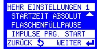
Um diese Zeit zu verkürzen und damit kontrollieren zu können, ob das Gerät korrekt funktioniert, kann man hier auch für die digitalen Impulse einen Startwert vorgeben, um die Zeit bis zur ersten Probenahme zu verkürzen.
